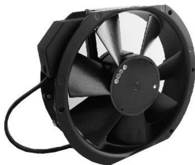
Компания «Техноконтракт-Вент» начинает поставку осевых специальных вентиляторов серии ЭВ одного из ведущих отечественных производителей Промышленно-производственной группы «ИОЛЛА» и предлагает электровентилятор **1,4ЭВ-3,6-5-1270**, который изготовлен в алюминиевом корпусе с новыми габаритно-присоединительными размерами, унифицированный с европейскими аналогами (**EBM-PAPST 7450ES, SUNON A2175**). Кроме того, разработанная с новой геометрией крыльчатка, обеспечивает более высокую
